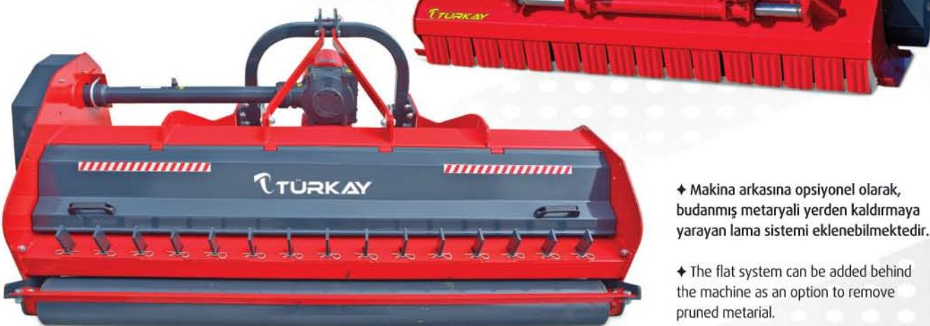
♦ Makina arkasına opsiyonel olarak, budanmış metaryalı yerden kaldırımı yarayan lama sistemi eklenebilmektedir.
